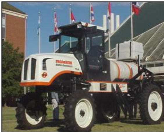
Figura 5. El aplicador Cherokee, este aspersor cubre 18 m en un pase y cuenta con sensores montados cada 0.6 m.
