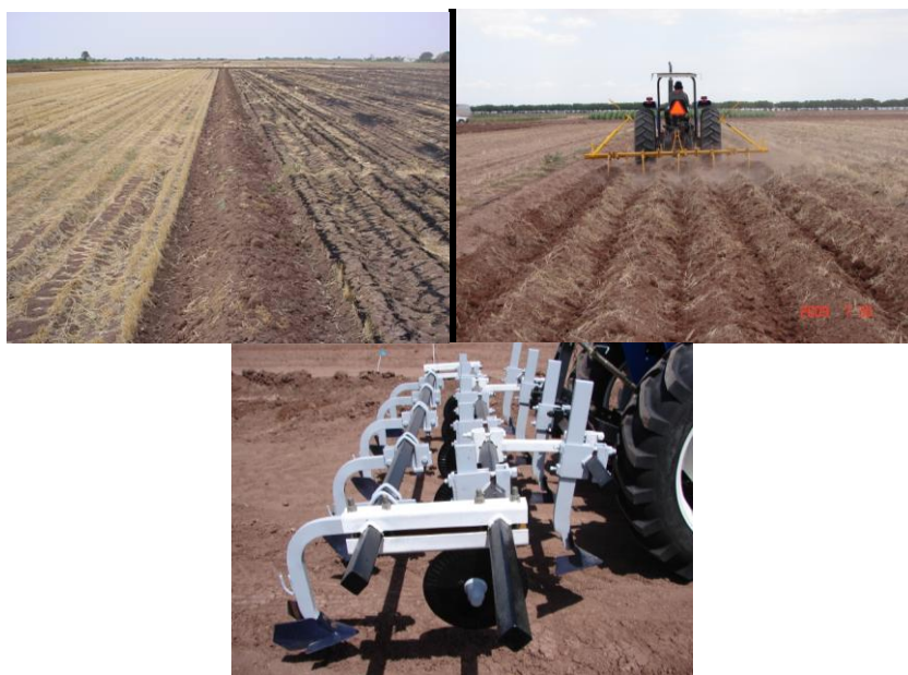
Figura 4. Lotes experimentales, surco reutilizado con toda la paja y equipo adaptado para esta labor
