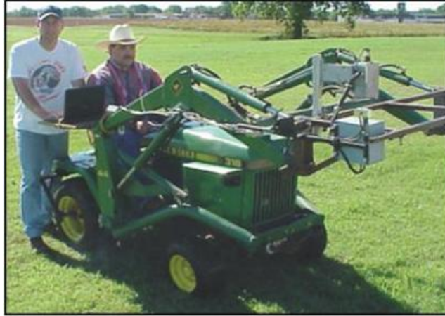
Figura 1. Lecturas de NDVI siendo obtenidas en pasto bermuda, Stillwater, OK. 1997.
