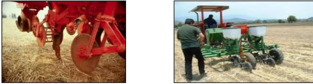
Figura 1. Siembra directa sin mover el suelo. Un disco cortador abre el suelo, se deposita la semilla y la llanta compactadora vuelve a cerrar el suelo.
