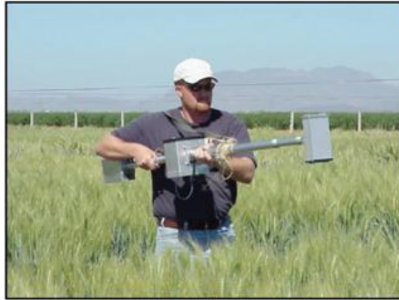
Figura 2. Sensor pasivo midiendo la reflectancia en trigo de primavera, Ciudad Obregón, Sonora, México.
