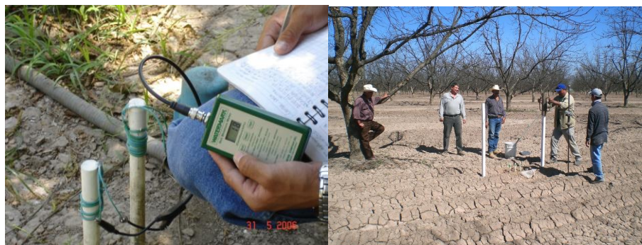
Figura 2. Establecimiento de estaciones de monitoreo de humedad y toma de lecturas con medidor digital.
